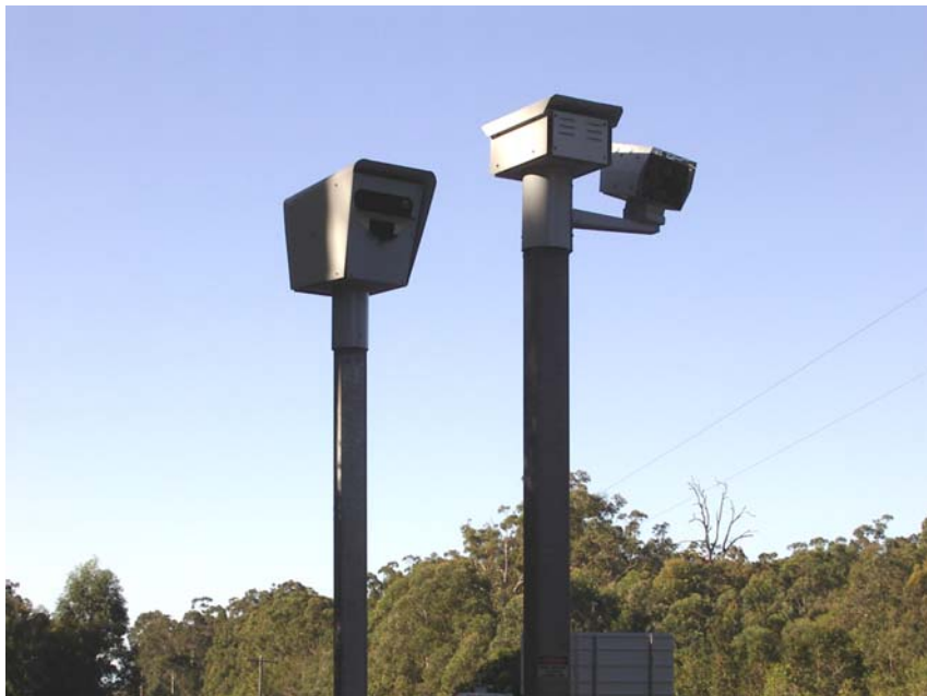
Figur 3.10 Mätplats med sträck- och punktmättningskameror i New South Wales, Australien (Källa: Redflex Traffic Systems Pty Ltd)
