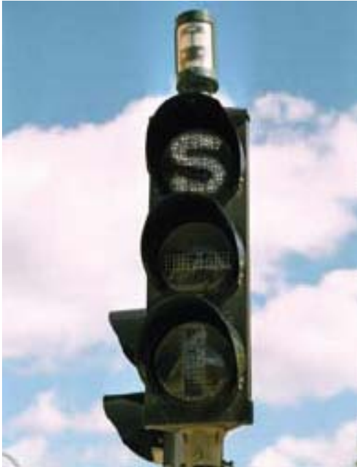
Figur: Signallykta med indikeringslampa av Stockholmstyp
